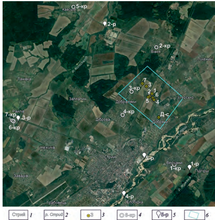
Рис. 1. Схема розташування газових свердловин та точок відбору проб води: 1 – населені пункти; 2 – річки; 3 – точки відбору підземних вод; 4 – точки відбору ґрунтових вод; 5 – точки відбору поверхневих вод; 6 – межа Добрівлянської площі
